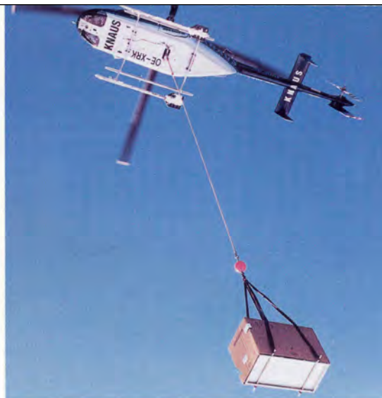
▲ Die Wärmepumpe wurde mit dem Hubschrauber zur Hütte geflogen
